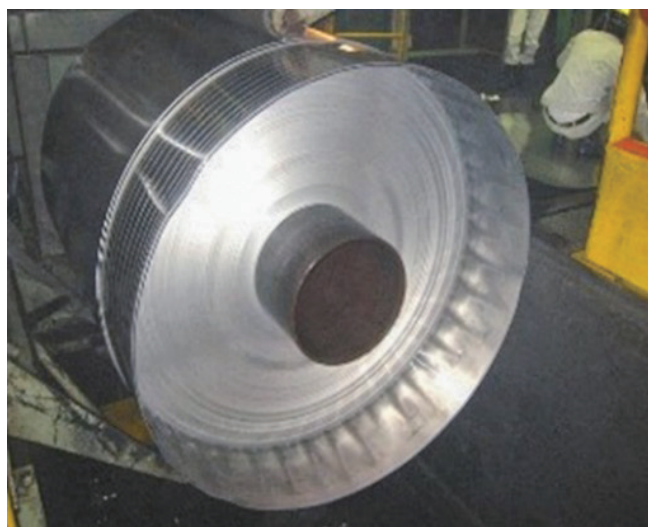
図2 蛇行発生コイル
