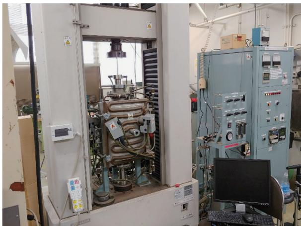
図1 高温鍛造試験機
