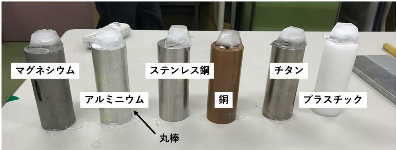
図 種々の材料の上に氷を載せて解けるまでの時間を測定。
