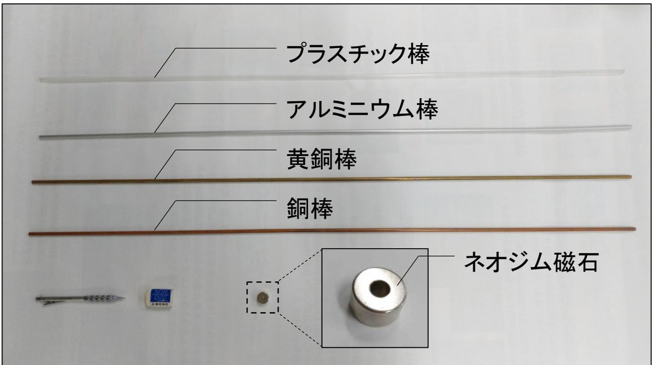
実験に用いる金属・プラスチック棒およびネオジム磁石
